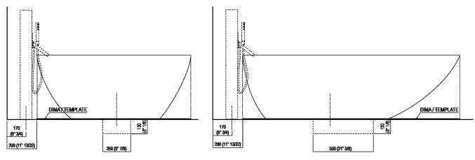
Per un corretto posizionamento del pozzetto e della rubinetteria è necessario utilizzare la dima in cartone con sagoma uguale al profilo superiore della vasca. For a correct positioning of the recess and the tap it is necessary to use the carton template with the shape of the upper rim of the bathtub.
