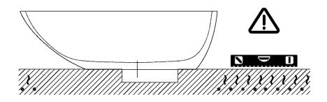
La vasca deve essere installata su un pavimento perfettamente piano. The bathtub must be positioned on a flat floor surface.
