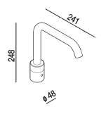
Bocca lavabo da piano con sensore elettronico, dotata di elettrovalvola esterna per miscelazione acqua (alimentatore 6V incluso). La bocca con sensore elettronico deve essere utilizzata solo con lavabi ad incasso.
