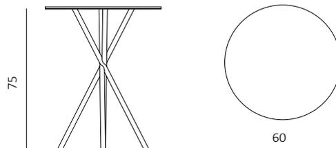
Tavolo in tubolare di acciaio diametro 25 mm zincato e verniciato a polvere.
