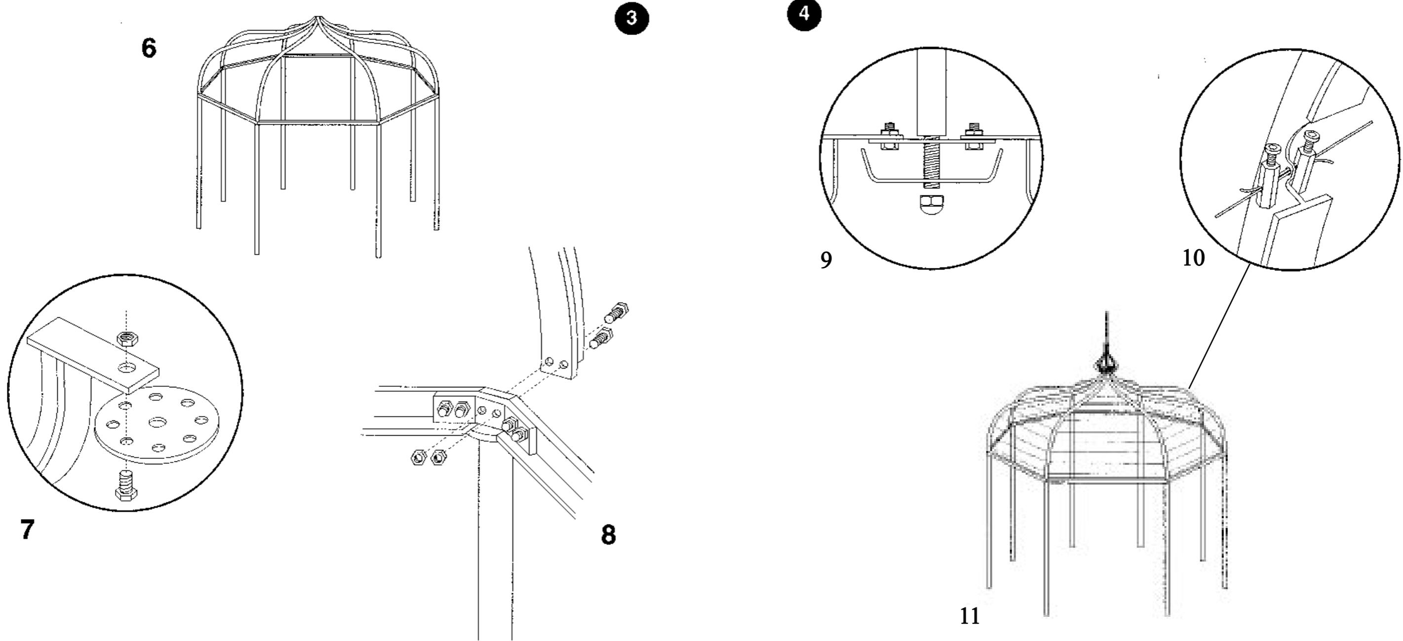
Fissare un puntone al giunto ad otto vie utilizzando un bullone da mm 10 x 25 e relativo dado dopodichè togliere i due bulloni da mm 8 x 30 (avvitati provvisoriamente) sulla testa di un pilastro accostarci la base del puntone quindi fissarlo tramite i due bulloni da mm 8 x 30. Ripetere l'operazione appena descritta per il fissaggio dei rimanenti puntoni.
